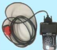
BANZAI MST2000 こちらの機材を使用して故障診断します。
